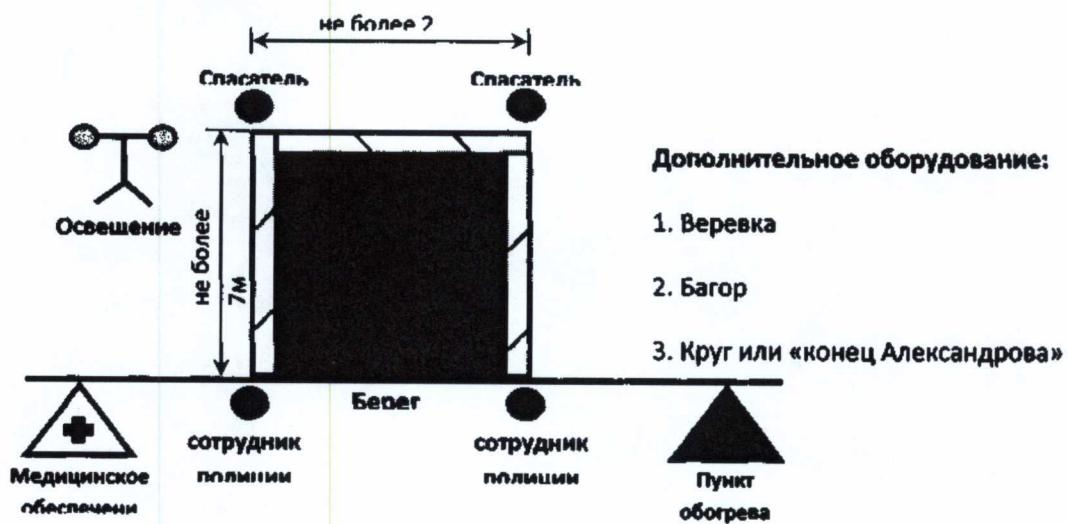
2. Схема расположения сил и средств, обеспечивающих безопасность при входе в купель со льда.
